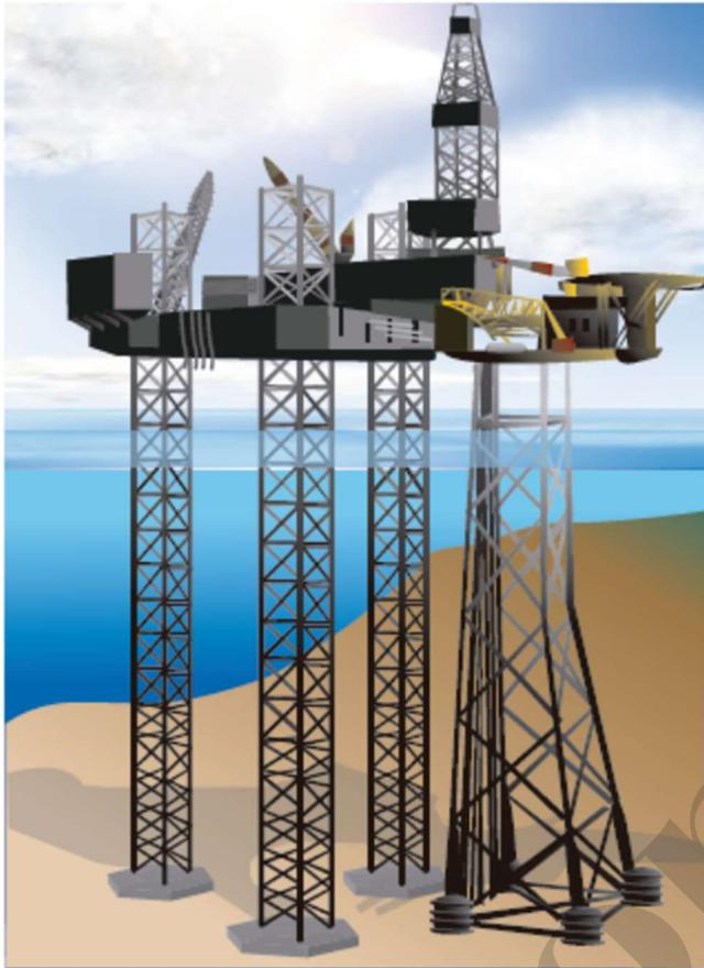
Fig. 14- Jack-up junto a una plataforma fija
