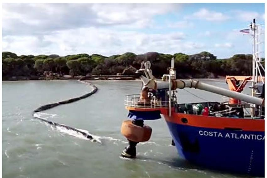
Los sedimentos han sido trasladados a través de una tubería de impulsión.
