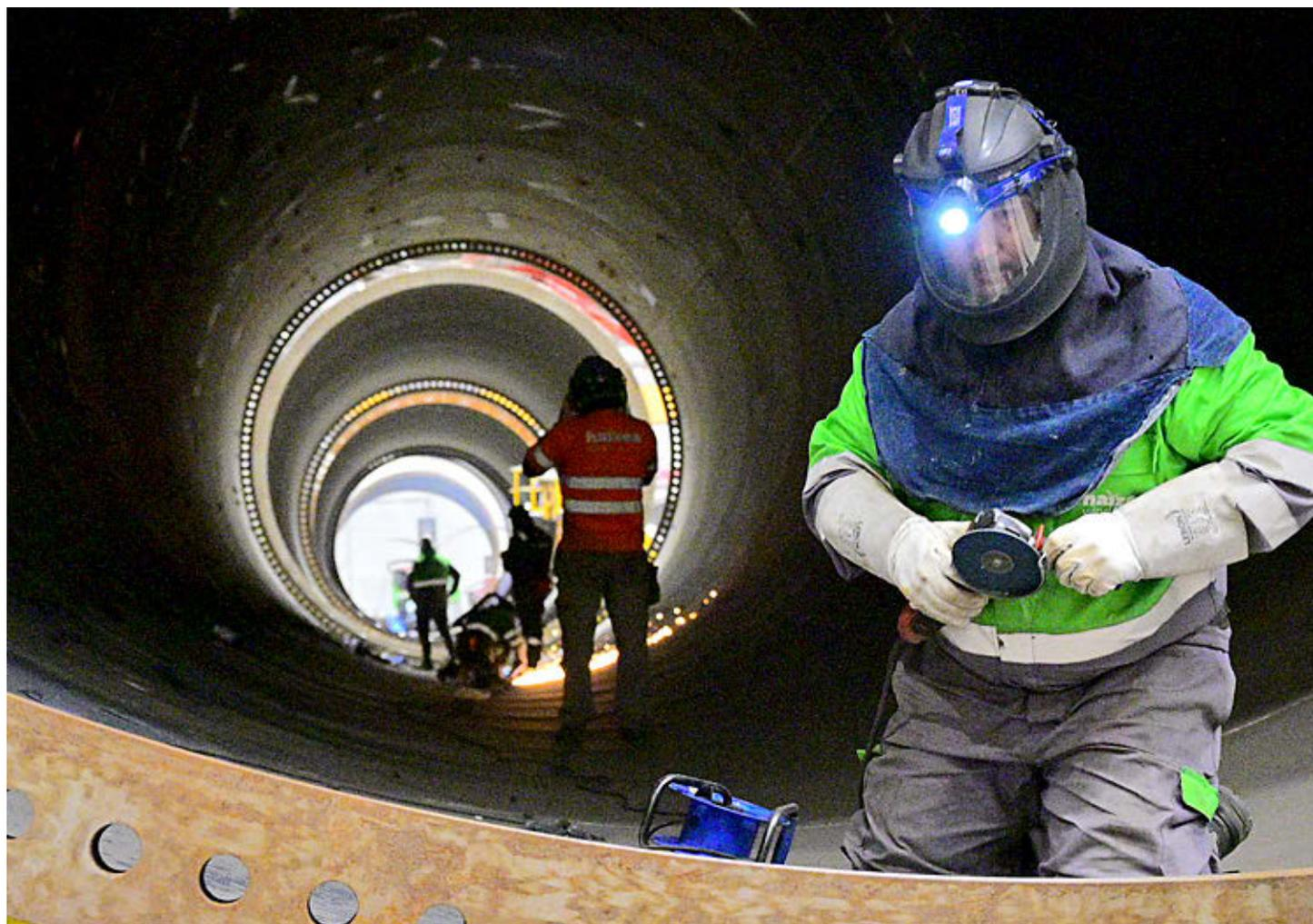
Operarios de Haizea Wind trabajan en el interior de un monopilote, estructura para la cimentación de parques eólicos.
