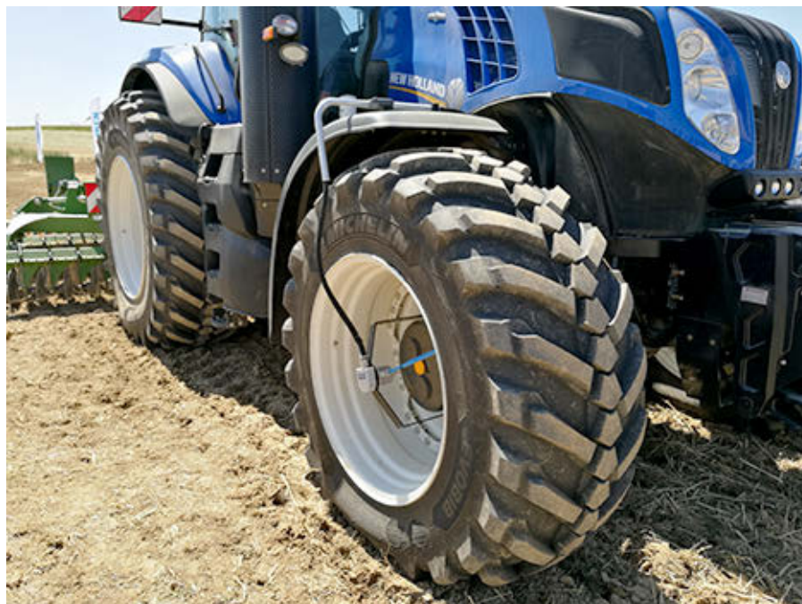
Los neumáticos de Michelin son compatibles con los sistemas de teleinflado. EE
