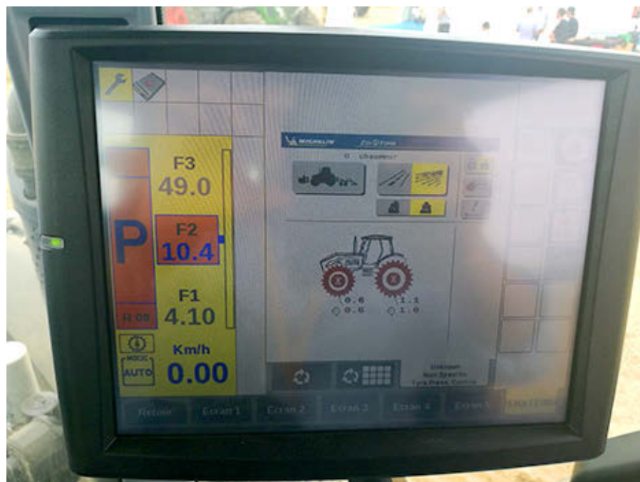
El sistema de teleinflado permite cambiar la presión de los neumáticos desde la cabina. EE
