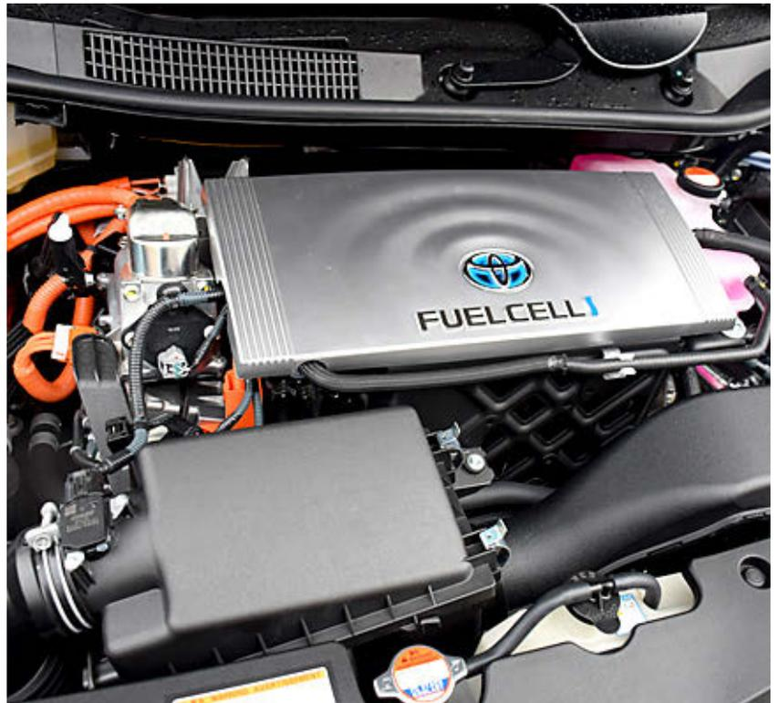
**Motor de un vehículo de pila de combustible.**
