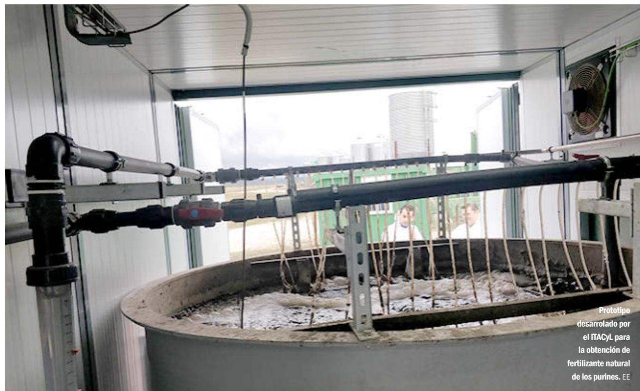
Prototipo desarrollado por el ITACyL para la obtención de fertilizante natural de los purines. EE
