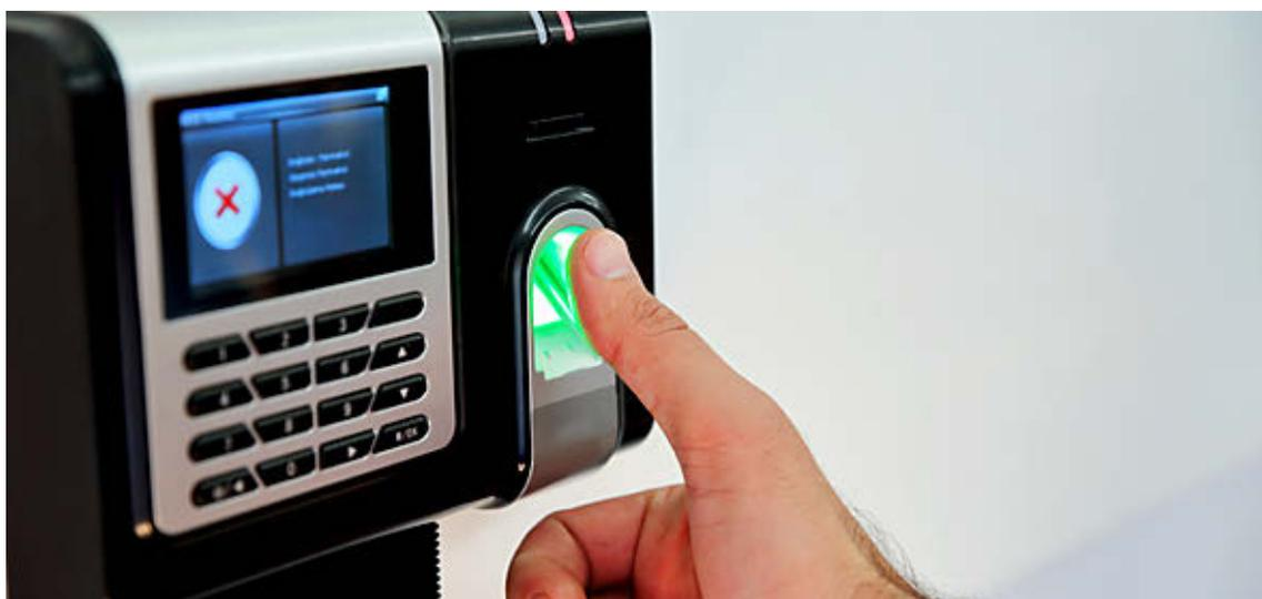
Control de acceso biométrico mediante huella dactilar.
