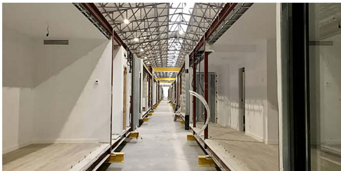
**Casas industrializadas construidas en fábricas por módulos que luego se montan en la obra.**
