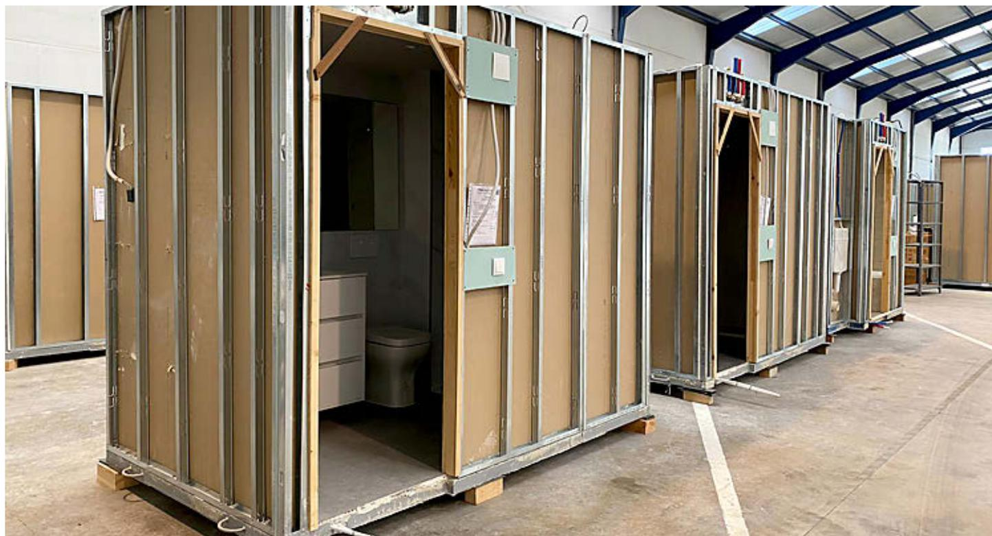
Los baños industrializados de Lignum Tech listos en la fábrica para ser ensamblados en obra.
