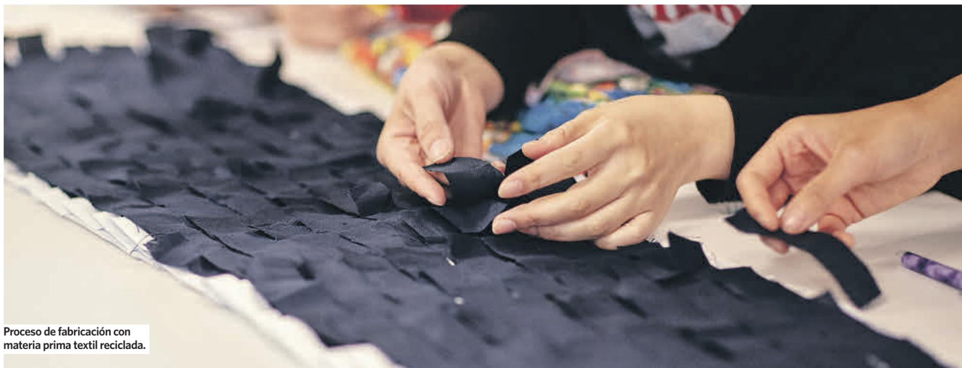
Proceso de fabricación con materia prima textil reciclada.
