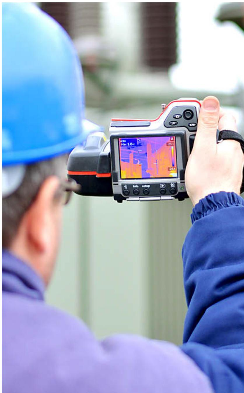
Pruebas sobre un edificio con una cámara termográfica.
