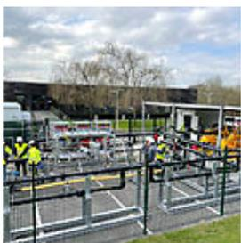
Nortegas ha finalizado con éxito la segunda fase de pruebas de su proyecto H2SAREA, en la que ha inyectado una mezcla del 10% de hidrógeno y 90% de gas natural durante 3.000 horas en una réplica de la red de distribución de gas natural actual, con elementos reales de la red de distribución que llevan más de 20 años en operación. Así lo recoge el estudio "Resultados de evaluación de pruebas para mezclas del 10% H2 y estudio de casos industriales",
