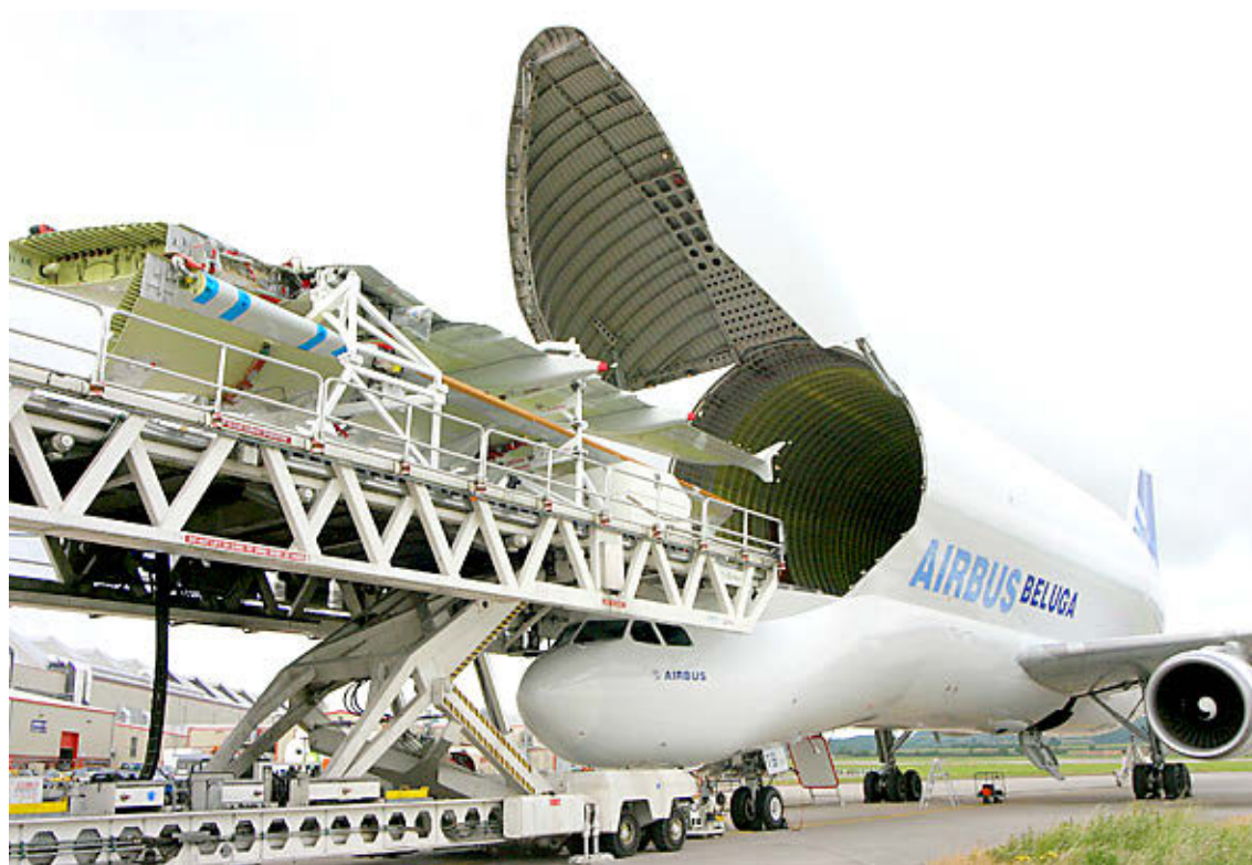
El avión de transporte de Airbus Beluga cargando componentes aéreos.
