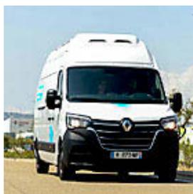
El hidrógeno verde se va abriendo paso en el sector de la movilidad con nuevos modelos como la furgoneta Renault Master Van H2-Tech, que tiene una capacidad para recorrer entre 400 y 500 kilómetros sin necesidad de repostar. Esta es una de las principales características de esta furgoneta de hidrógeno verde, novedad a nivel mundial en su segmento -volumen de carga de 12 metros cúbicos-, y diseñada para el uso profesional, que se ha presentado
