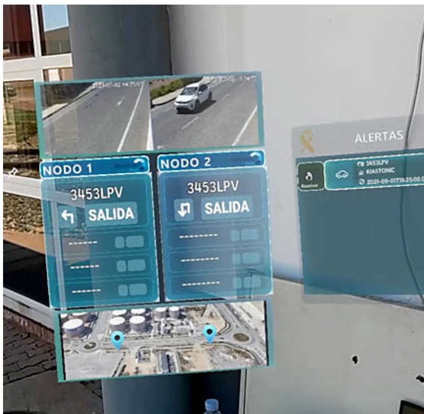
El sistema reconoce las matrículas y va guiando a los vehículos por el puerto.eE
